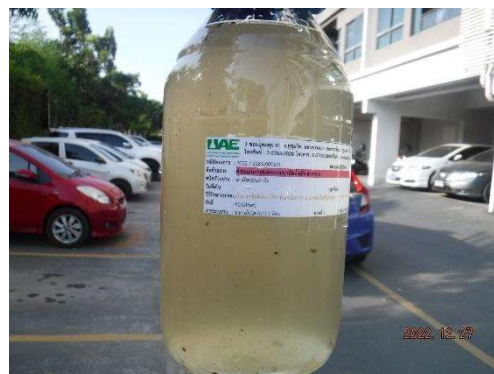
(1) ส่วนแยกกากของระบบบำบัดน้ำเสีย อาคาร A
